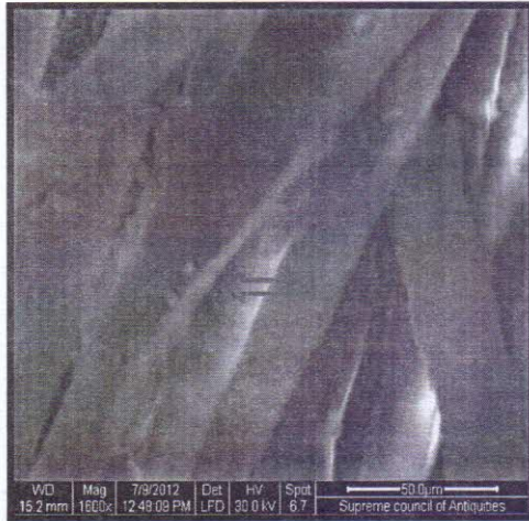
(صورة ١٦) تآكل الطبقة السطحية للألياف
